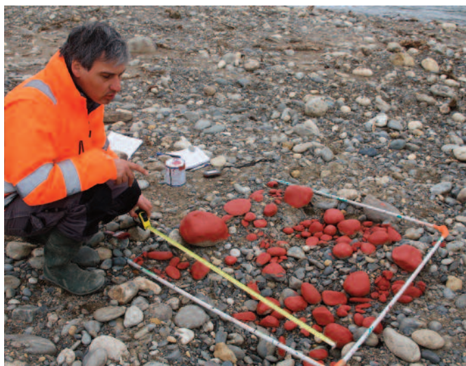
Préparation d'un des échantillons de galets sur 1 m 2 par Paul Simon, technicien du SIVOM des Plaines et Coteaux du Volvestre pour permettre de mesurer la capacité du fleuve à remobiliser ses galets.
