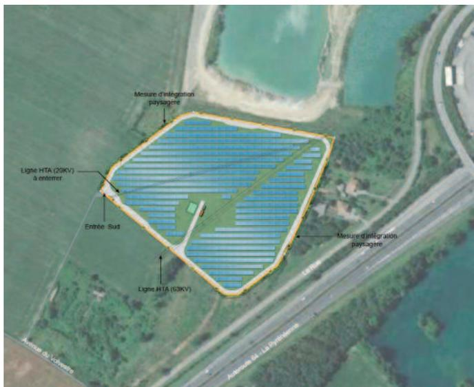
Implantation de la centrale photovoltaïque prévue le long de l'A64 au lieu-dit La Rue. 12 897 m<sup>2</sup> de surface de panneaux photovoltaïques.
