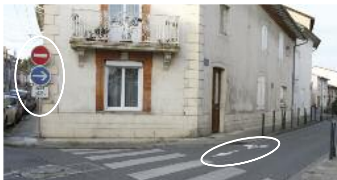
Le double sens cyclable est matérialisé par le marquage au sol et la signalétique verticale.
