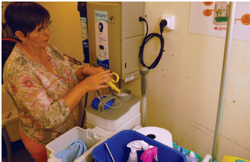
L'eau ozonée est utilisée dans les quatre heures pour la désinfection et dans les trois jours pour le nettoyage des sols.
